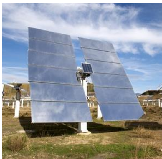
Figura 16. Heliostato autónomo en el campo CRS.
