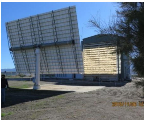
Figura 22. Helióstato HT120 en seguimiento solar.
