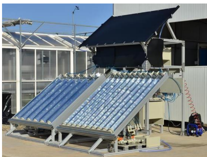
Figura 37. Vista del nuevo CPC y fotorreactores tipo-U (NOVA 75 V 1.0).
