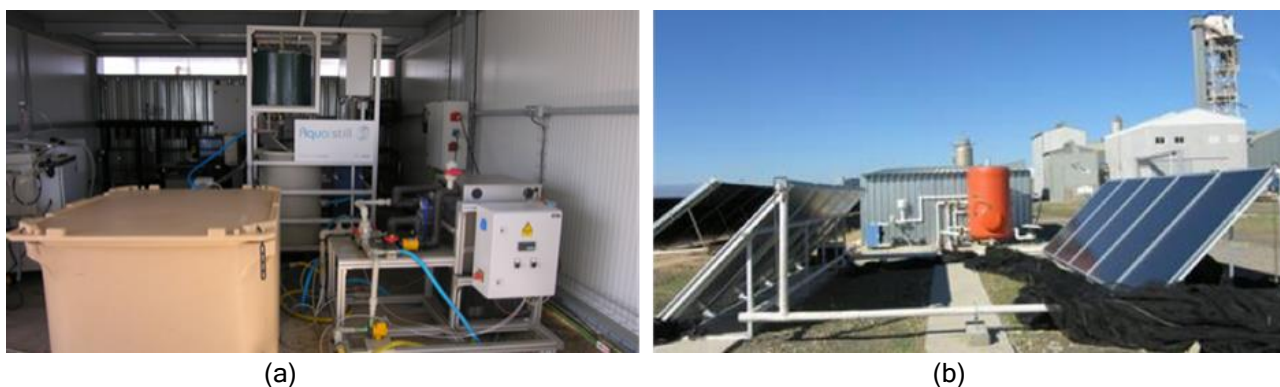
Figura 31. Vistas interior (a) y exterior (b) del banco de ensayos experimental de Destilación por Membranas dentro de la instalación de Desalación solar térmica de la PSA
